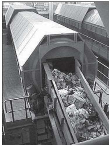
Figura 7: Tropel de planta de separación y clasificación de bolsa de resto
